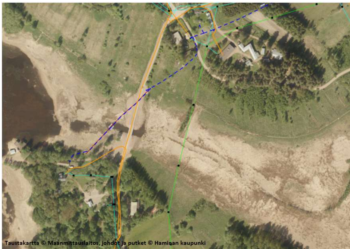
Kuva 10. Uittimiensalmen alueella kulkevat johdot ja putket. Kymenlaakson sähkön ilmajohto (vihreä), Telian kaapeli (oranssi), sekä Haminan veden vesijohto ja painevesiviemäri (sininen katkoviiva ja ruskea viiva).
